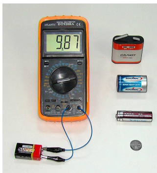
Рис. 1. Измерение напряжения мультиметром. Учащимся выдают мультиметр и несколько источников тока. Школьники определяют и записывают тип каждого источника, зарисовывают источник тока схематически в рабочей тетради и указывают измеренное значение напряжения на его полюсах
